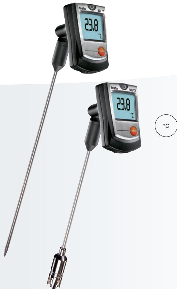
Le testo 905-T1 est un thermomètre de pénétration particulièrement rapide avec une plage de mesure étendue de -50 à +350 °C, à court terme même jusqu'à +500 °C (1 à 2 minutes). Cet appareil de mesure est doté d'un capteur industriel professionnel (thermocouple de type K). Il présente une précision exceptionnelle, tout particulièrement dans sa plage de mesure supérieure.
