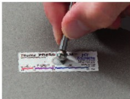
Bâtonnet de frottement en acier inox pour une empreinte régulière
